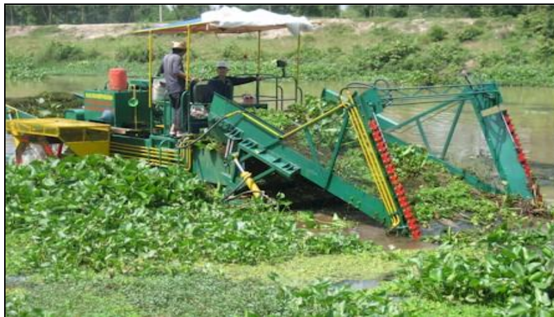
Hình 12: Thiết bị cắt - vớt rong cỏ, lực bình của trường Đại học Công nghiệp TP HCM
